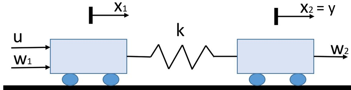
$$\begin{bmatrix} \dot{x}_1 \\ \dot{x}_2 \\ \dot{x}_3 \\ \dot{x}_4 \end{bmatrix} = \begin{bmatrix} 0 & 0 & 1 & 0 \\ 0 & 0 & 0 & 1 \\ -k/m_1 & k/m_1 & 0 & 0 \\ k/m_2 & -k/m_2 & 0 & 0 \end{bmatrix} \begin{bmatrix} x_1 \\ x_2 \\ x_3 \\ x_4 \end{bmatrix} + \begin{bmatrix} 0 \\ 0 \\ 1/m_1 \\ 0 \end{bmatrix} u + \begin{bmatrix} 0 & 0 \\ 0 & 0 \\ 1/m_1 & 0 \\ 0 & 1/m_2 \end{bmatrix} \begin{bmatrix} w_1 \\ w_2 \end{bmatrix}$$
